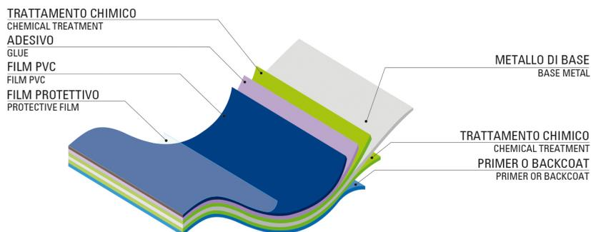
VARPVC è formato da un supporto metallico prerivestito con film di PVC. Il film può essere in tinta unita o stampato, con una finitura liscia oppure goffrata e, grazie alle sue caratteristiche quali idoneità al contatto con alimenti, resistenza al fuoco, lavorabilità meccanica, può essere impiegato in molteplici settori e per le più svariate applicazioni. Inoltre, la possibilità di poter applicare il film di PVC su entrambi i lati lo rende ancora più versatile.
